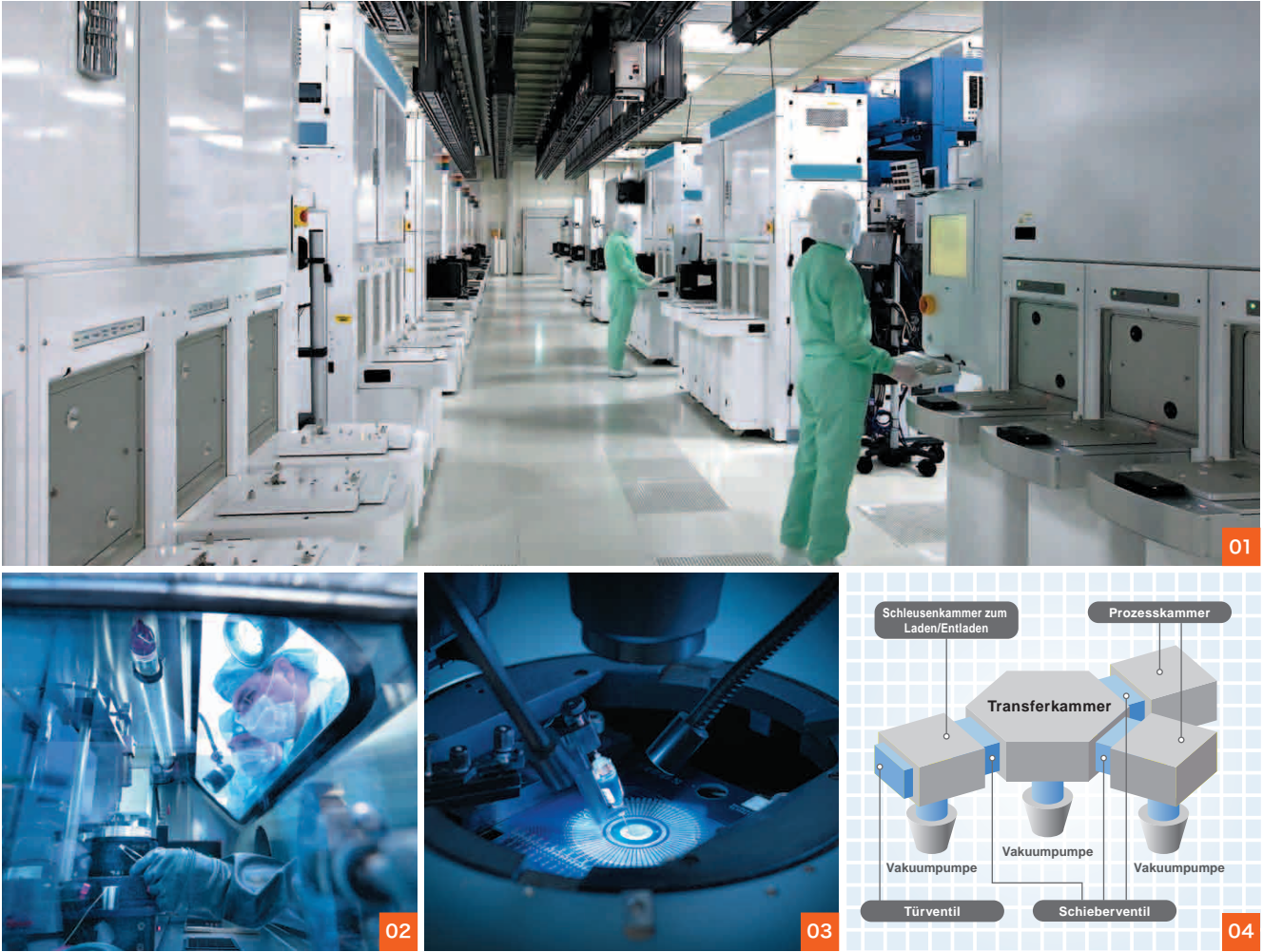
01. Hightech-Halbleiter-Werk (Reinraum) mit aneinandergereihten Anlagen für die Halbleiterherstellung (Foto mit freundlicher Genehmigung der Toshiba Memory Corporation) 02. Betrieb im Handschuhkasten, der hermetisch gegenüber Sauerstoff und Wasser abgeschlossen ist 03. Elektrische Prüfung eines Siliziumwafers 04. Schematische Darstellung eines Cluster-Tools in der Fertigungsanlage
