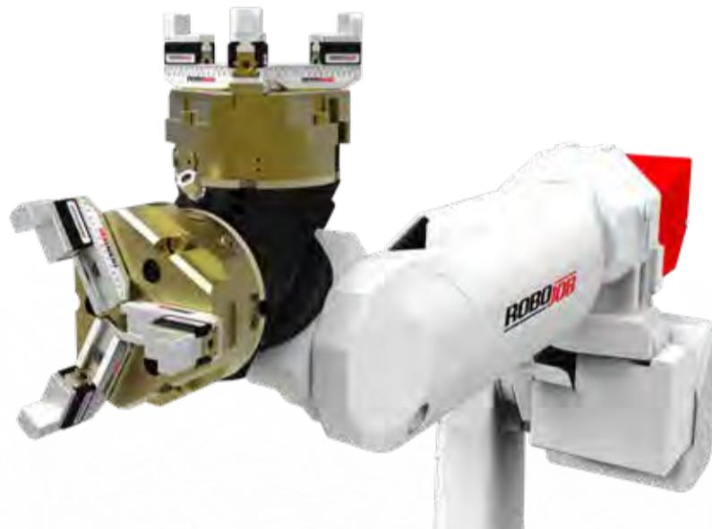
Sowohl der Mill-Assist Essential Integrated (zum Fräsen) als auch der Turn-Assist 270 Integrated (zum Drehen) sind die ideale Lösung für kleine Serien mit Werkstücken von bis zu 270 mm. Die Nutzlast ist je nach dem gewählten Modell unterschiedlich. Sie haben die Wahl zwischen 20 kg oder 35 kg bei einem MA E i; und bei einem TA 270 i können Sie sich zwischen einem Robot mit einer Nutzlast von 20 kg oder von 35 kg entscheiden.
